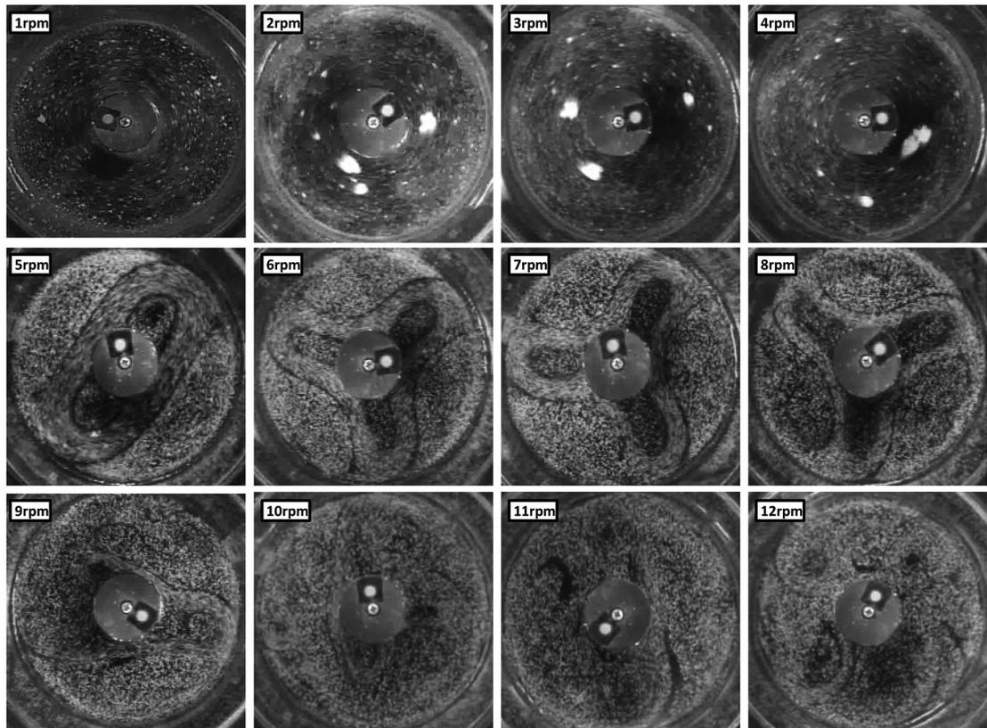
第1図 高感度カメラで撮影された水面の画像。実験条件は水深4 cm, 水平温度差 $20^{\circ}\text{C}$ , 回転速度1 rpm~12 rpm. 1段目左から1~4 rpm 実験, 2段目左から5~8 rpm 実験, 3段目左から9~12 rpm 実験.
