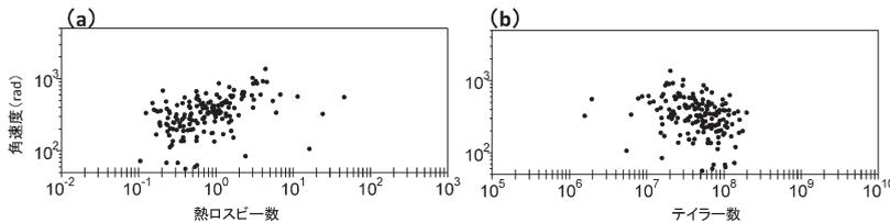
第9図 規則運動の位相角速度を(a)熱ロスビー数と(b)テイラー数を用いて示した散布図。位相角速度は、水の粘性係数と水槽の幅の2乗の比で割ることで、無次元数としている。
