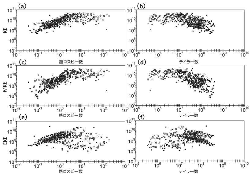
第 6 図 無次元パラメータである熱ロスビー数とテイラー数を用いて全解析結果の時間平均 (a) (b) KE, (c) (d) MKE, (e) (f) EKE を示した散布図。エネルギーは、水の粘性係数の 2 乗と水槽の幅の 2 乗の比で割ることで、無次元数としている。(a) (c) (e) は熱ロスビー数、(b) (d) (f) はテイラー数に対応する。● : 2 cm, ○ : 4 cm, □ : 6 cm, ◆ : 8 cm。
