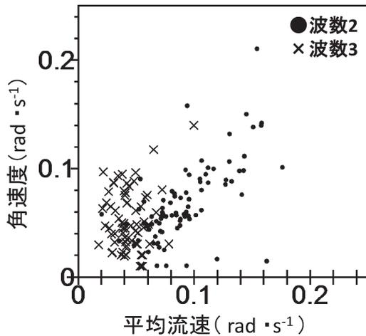
第10図 平均流速と波数の位相角速度の散布図。
