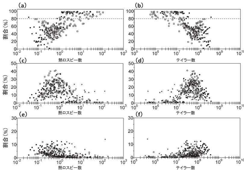
第7図 (a) (b)時間平均したKEのなかのMKEが占める割合、(c) (d)EKEのなかでも卓越波(波数 $M$ )のEKE割合、(e) (f)卓越波のとなりのサイドバンド(波数 $M \pm 1$ )のEKE割合を表した散布図である。(a) (c) (e)は熱ロスビー数、(b) (d) (f)はテイラー数に対応する。
