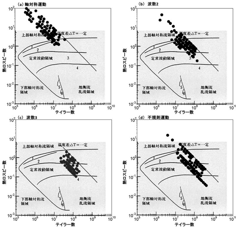
第8図 菊地ほか (1988) のレジーム・ダイアグラム上に、本研究で定量的に解析した実験結果をプロットして重ねた図である。(a)軸対称運動、(b)規則運動の波数2、(c)規則運動の波数3、(d)不規則運動。
