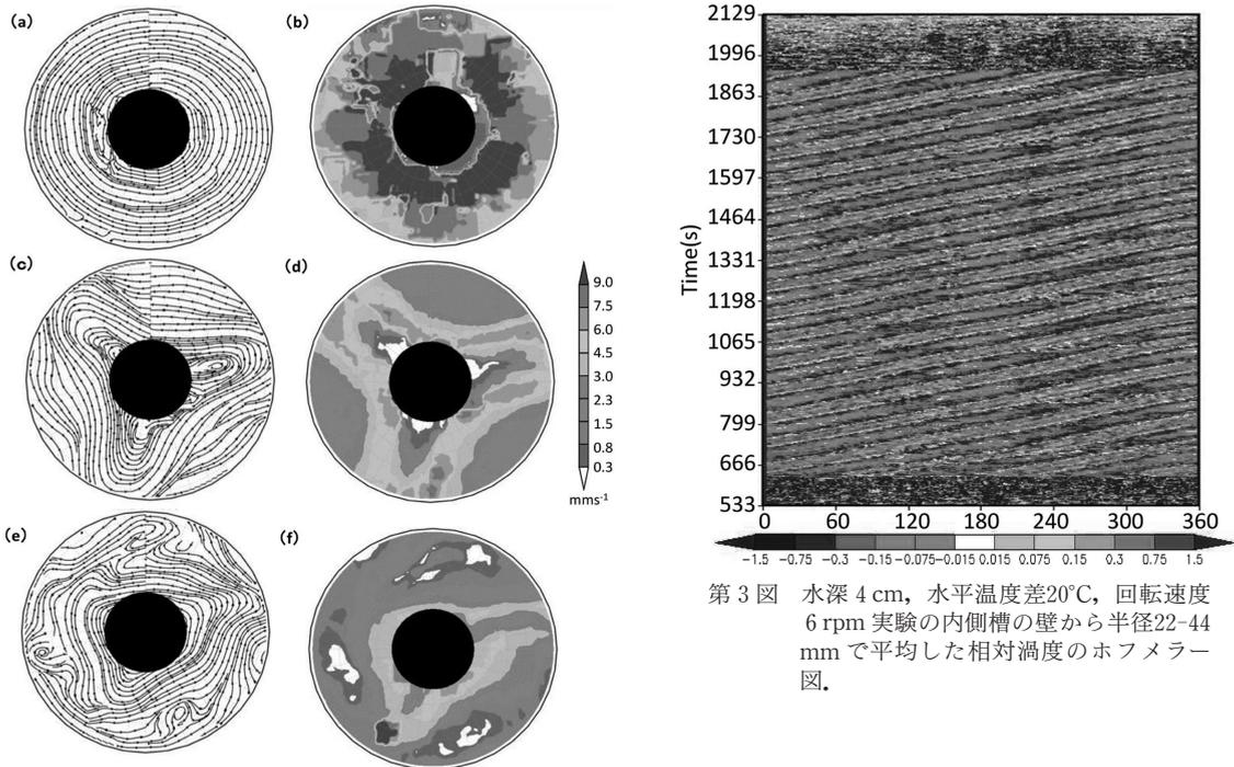
第3図 水深4 cm, 水平温度差20°C, 回転速度6 rpm 実験の内側槽の壁から半径22-44 mm で平均した相対渦度のホフメラー図.
