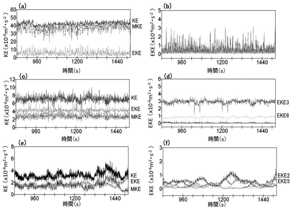
第4図 内側槽の壁から半径22-44 mm で平均した (a) (c) (e) KE, MKE, EKE の時間変化と, (b) (d) (f) 波数別 EKE の時間変化. 水深4 cm, 水平温度差20°C, (a) (b) 2 rpm 実験, (c) (d) 6 rpm 実験, (e) (f) 11 rpm 実験.
