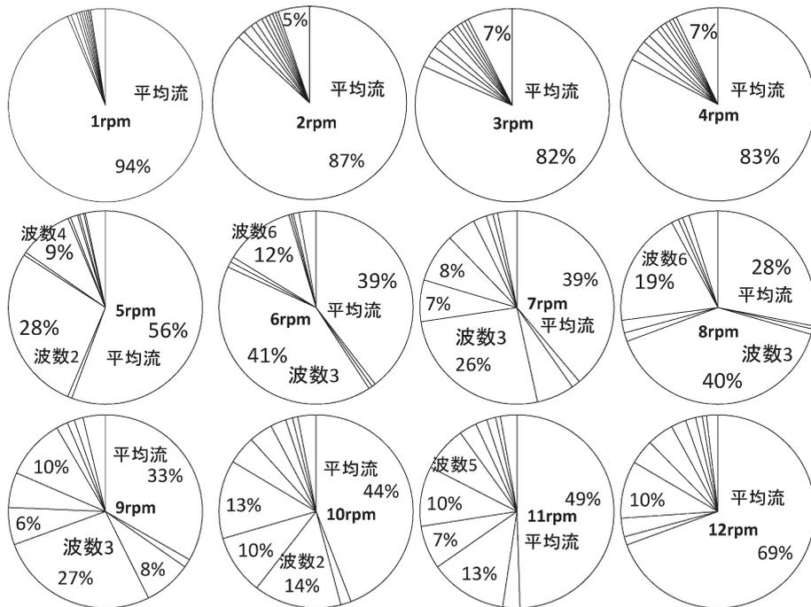
第 5 図 第 1 図で示した実験の時間平均した各運動エネルギー量を, 全 KE の中で割合で示した円グラフ。円グラフの真上から時計回りに MKE, 波数 1~9 EKE と高次波 EKE の占める割合を示す。
